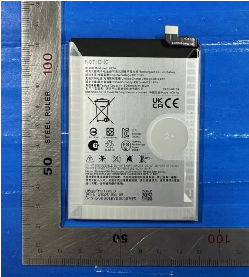
Single Cell Battery /单电芯电池 （NT04 3,89V 4920mAh 19,14Wh）
